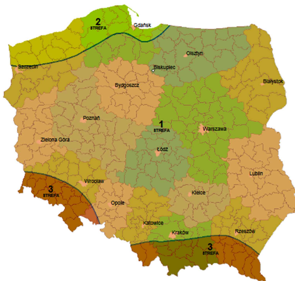
Rysunek 1. Strefy obciążenia wiatrem wg PN-EN 1991-1-4
